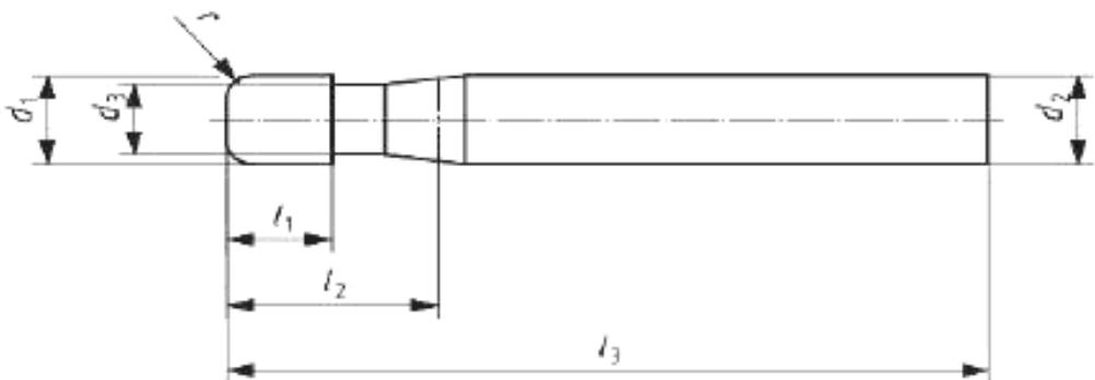
П р и м е ч а н и е — Диаметр цилиндрической части шейки  $d_3$  — по усмотрению изготовителя. Оба типа концевых фрез изготавливают как с шейкой, так и без нее.
